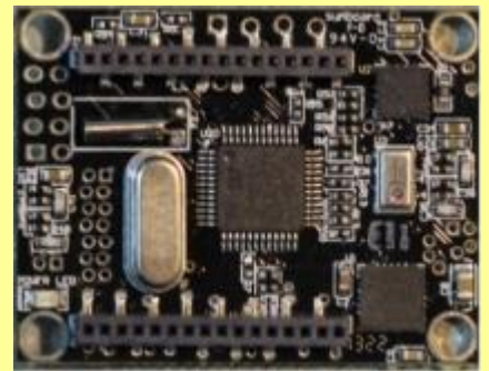
微型9-in-1智慧感測器模組 (整合三軸陀螺儀；三軸加速度計；三軸磁力計；氣壓計；溫度、濕度、亮度感測器以及微控制器)
